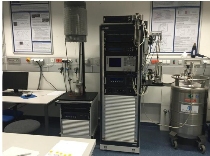
Abbildung 32: Impedanz-Gerät: *Novocontrol Concept 80 Impedance Spektrometer*.
