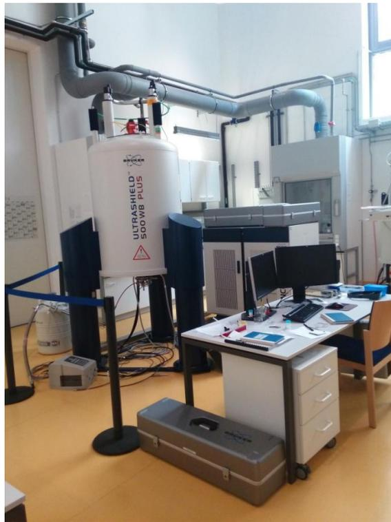
Abbildung 31 NMR Gerät: *Avance III 500 Spektrometer*.
