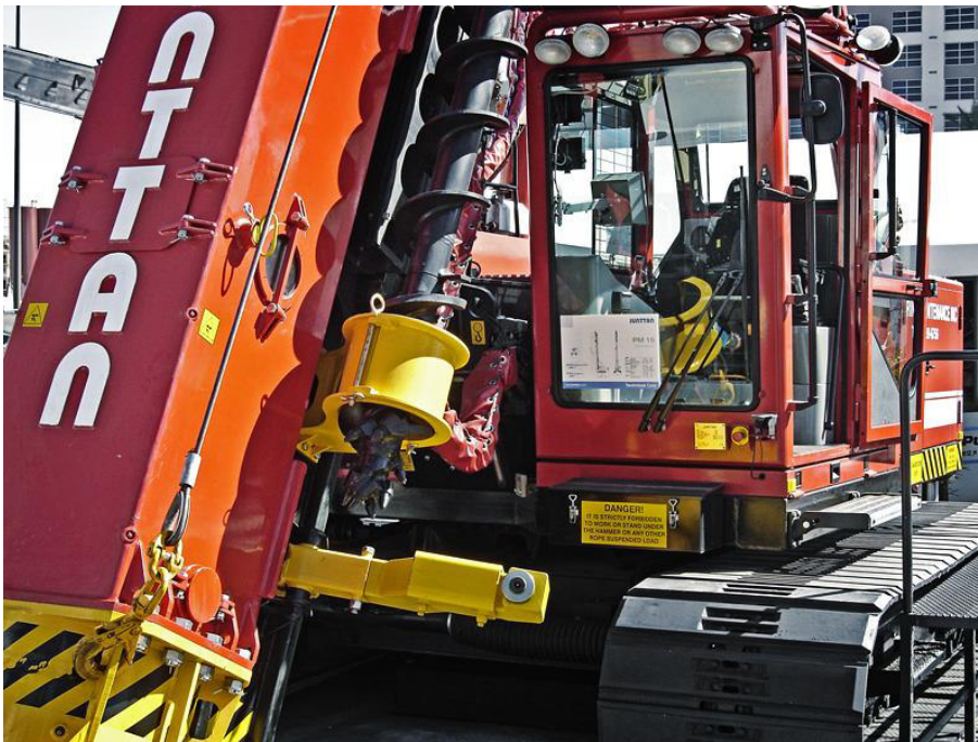
Abb. 5-6 Pfahlrammgerät Junttan PM 16 mit, an der Rammvorrichtung, montiertem Bohrer 91
