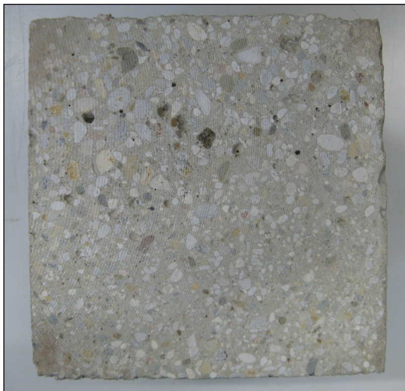
Abbildung 16 Geschnittene Probenoberfläche eines Chlorideindringungstest-Würfels mit einer Seitenlänge von 150 mm und noch ohne Butylklebeband
