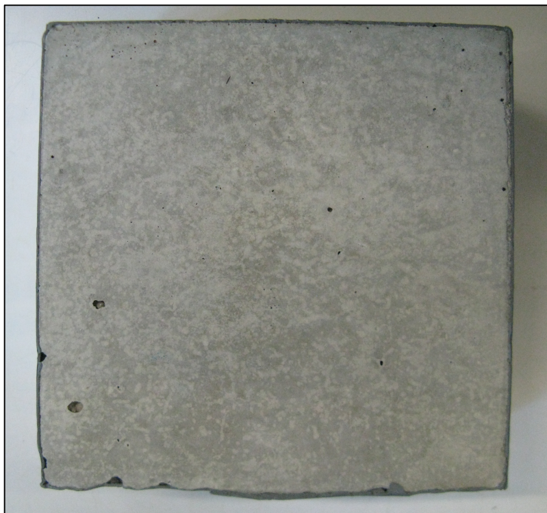
Abbildung 15 Geschalte Probenoberfläche eines CDF-Test-Würfels mit einer Seitenlänge von 150 mm und seitlich aufgeklebten Alu-Butyl-Band
