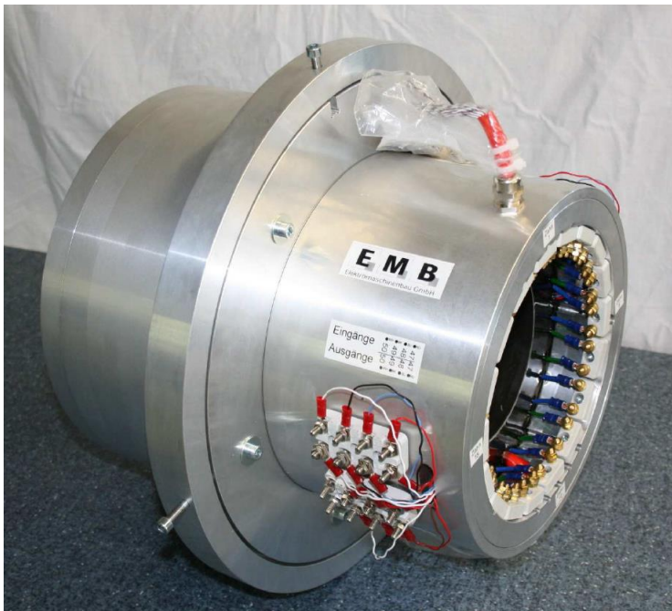
Abbildung 1: Versuchsmaschine: Permanentmagnet erregte Synchronmaschine (PMSM) [2] und die dazu gehörenden Typenschilddaten (vgl. [3])
