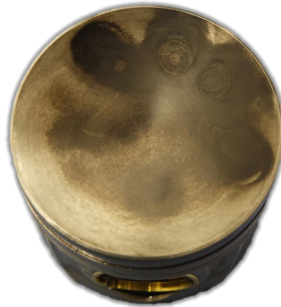
Bild 5.40: Benetzung des Linsenkolbens durch Dieseleinspritzung
