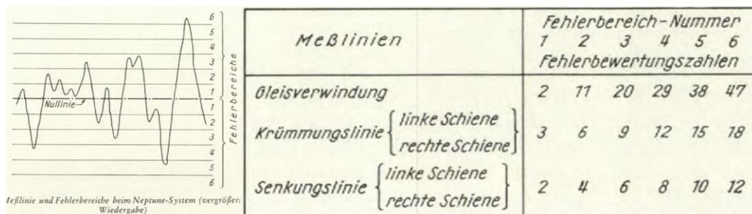
Abbildung 75: Fehlerbewertungssystem „Neptune“ [Schramm 1967]
