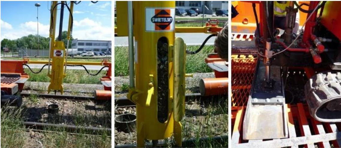
Abbildung 29: Gleisgebundene Drucksondierung (Links: eingerütteltes Hüllrohr, Mitte: Schotterentnahme, Rechts: Drucksonde)
