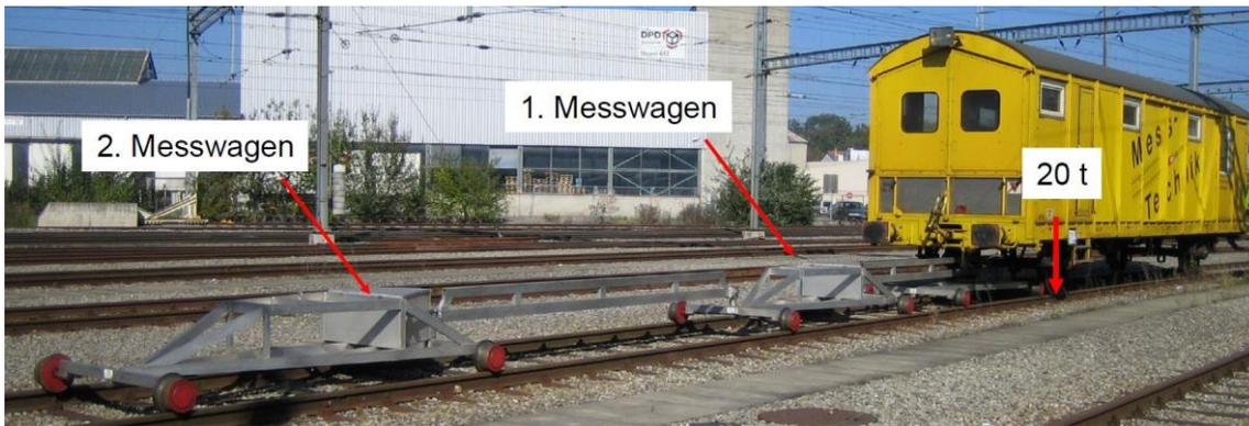
Abbildung 30: Eisenkungsmesswagen SBB [Soldati 2013]
