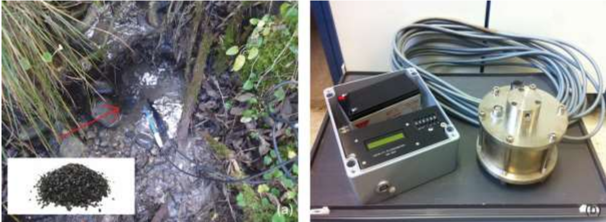
Abbildung 20 (a) Aktivkohle in einem Säckchen aus Nylon mit Maschengitter zur qualitativen Analyse. (b) GGUN FL30 Field Fluorometer 663 zur quantitativen Analyse.
