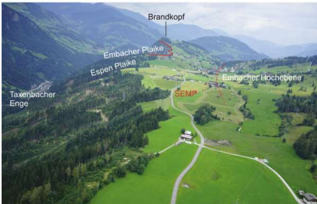
Abbildung 8 Die Morphologie der Taxenbacher Enge und Embacher Hochebene anhand eines Ausschnittes von Google Earth und einer Luftaufnahme des Landes Salzburg. Die rot-strichlierte Linie zeigt die SEMP, die rote durchgezogene Linie die Abrisskante der Embacher Plaike.
