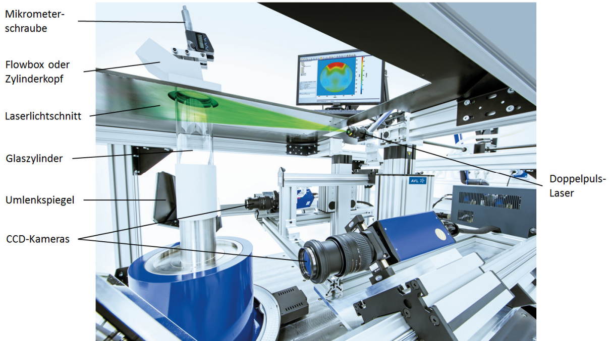
Abbildung 4-7: PIV-Strömungsprüfstand [22]
