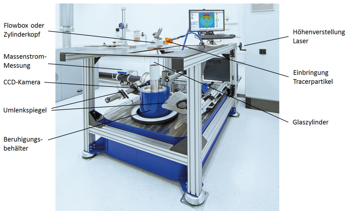
Abbildung 4-6: PIV-Strömungsprüfstand Gesamtübersicht [22]
