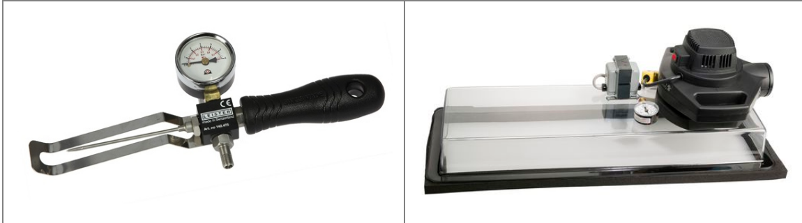
Abbildung 5-11: Druckluftprüfnadel (links, Firma Klappenbach), Vakuumprüfglocke (rechts) [44,112]
