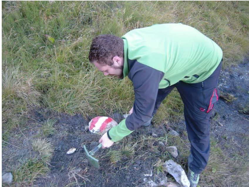
Abbildung 22: Freilegung eines Messpunktes, Foto Kaufmann 2014
