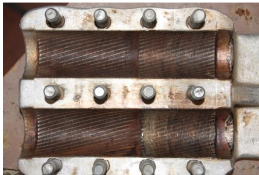
Bild 3-22 – BV 1: Seilklemme nach Zyklen
