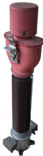
Bild 3-3 – Untersuchungsobjekt RITZ KOTEF 220 kV Kombiwandler
