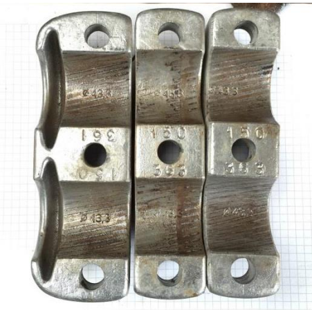
Bild 3-31 – BV 2: Seilklemme (oben) vor Umbau
