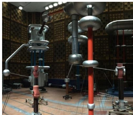
Bild 3-55 – Gesamtaufbau mit beiden Wandlern
