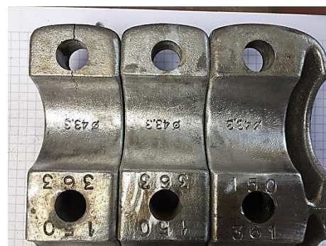
Bild 3-34 – BV 2: Seilklemme (Detail) nach Umbau
