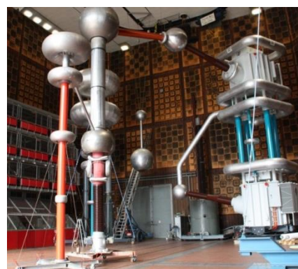
Bild 3-52 – Realer Messaufbau mit Koppelkondensator(links), Prüfling und Prüftrenntransformator (rechts)
