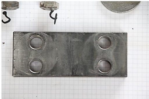
Bild 3-45 – BV 2: Verbindungsplatte (vorne) nach Umbau
