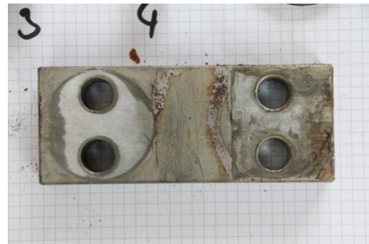
Bild 3-42 – BV 2: Verbindungslasche (hinten) vor Umbau
