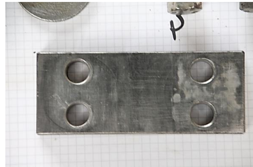
Bild 3-46 – BV 2: Verbindungsplatte (hinten) nach Umbau
