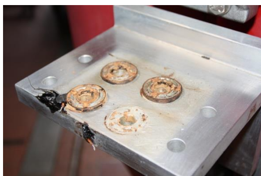
Bild 3-23 – BV 1: Winkellasche P1 mit Kontakttringen nach Zyklen
