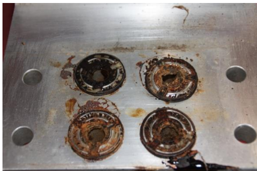
Bild 3-25 – BV 1: Winkellasche P2/A mit Kontaktringen nach Zyklen
