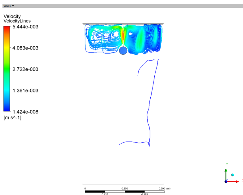
Bild 4-28 – Ölbewegung gegen Ende des Simulationszeitraums beim vereinfachten Modell
