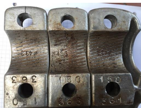
Bild 3-33 – BV 2: Seilklemme (Detail) vor Umbau
