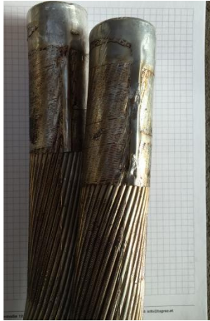
Bild 3-20 – BV 1: Leiterseilabschluss nach Zyklen
