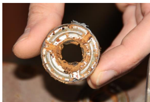
Bild 3-24 – BV 1: Kontakttring auf Seite P1 nach Zyklus
