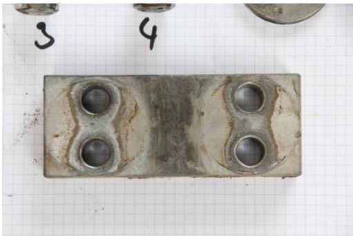
Bild 3-41 – BV 2: Verbindungslasche (vorne) vor Umbau
