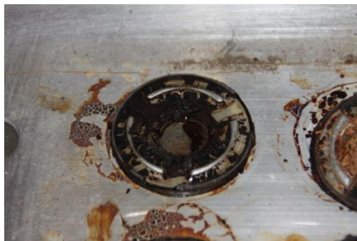
Bild 3-26 – BV 1: Kontaktring auf Seite P2/A nach Zyklus
