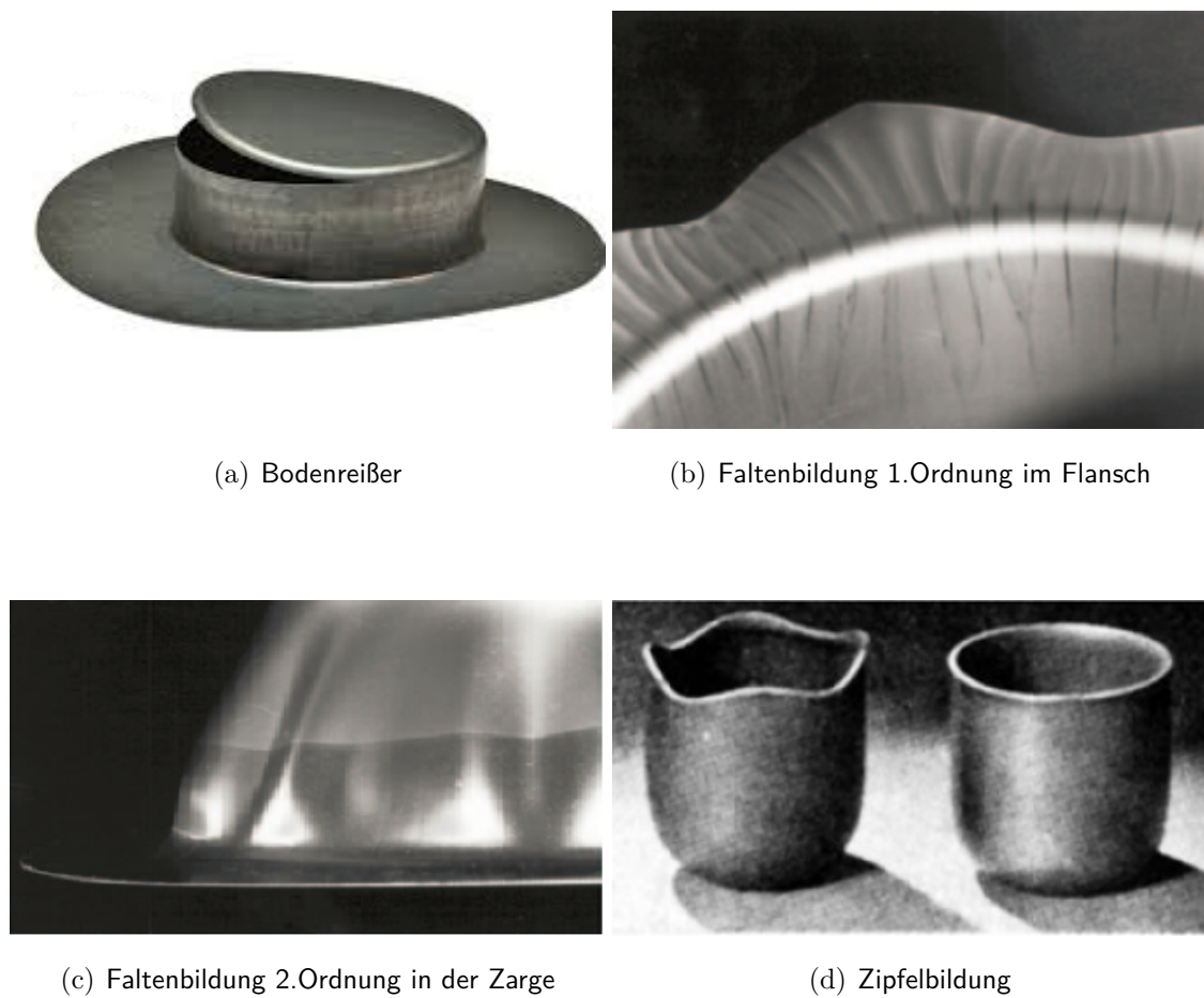
Abbildung 2.7: Versagensfälle beim Tiefziehen[16]
