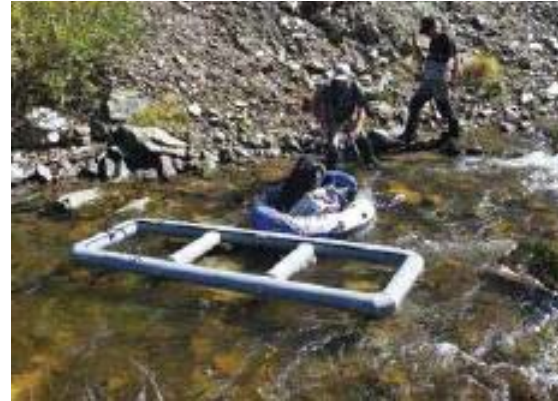
Abbildung C 1-7: FLOATING Antenne aufblasbar (Biomark, 2016)
