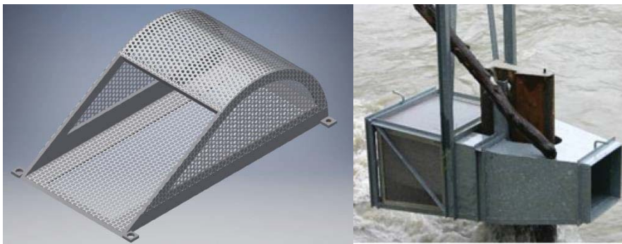
Abbildung A 8-1: Geschiebekorb NEU Oberwölz und TIWAG-Sammler (eigene Darstellung & Habersack, et al., 2012)
