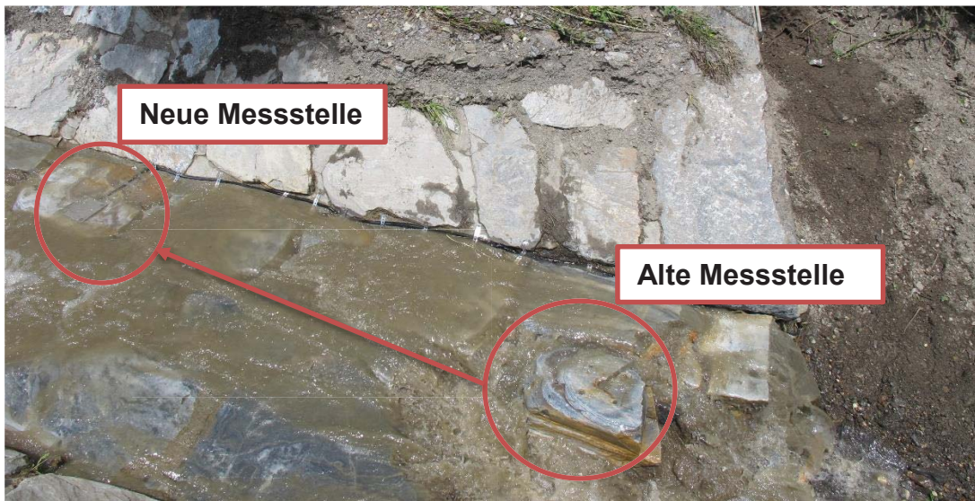
Abbildung B 2-12: Umlegung des Sensors - Schmiedbognerbach
