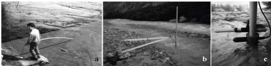
Abbildung B 1-10: manuelle Hydrophonmessung im Iser Wildbach (links); Messungen mit einer Stützapparatur im Saint Pierre Wildbach (mitte und rechts) (Belleudy, et al., 2010)
