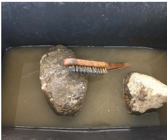
Abbildung C 4-1: Reinigung der Farbtracersteine mittels Drahtbürste
