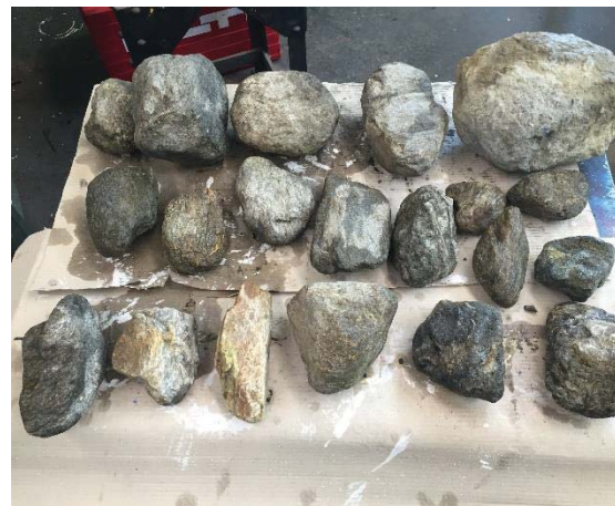
Abbildung C 4-2: Farbtracersteine nach Reinigung mittels Bremsenreiniger und Druckluft
