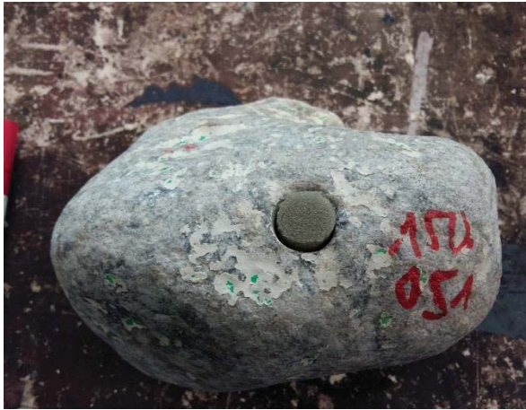
Abbildung C 5-2: Telemetriestein mit Schaumstoff
