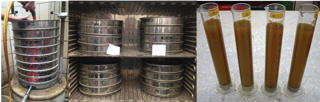
Abbildung B 3-1: Nasssiebung (li), Trocknung (mitte), Sedimentation (re)
