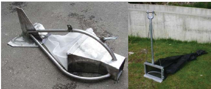
Abbildung A 8-2: Large Helley Smith und Vent-Sammler (eigene Darstellung & Habersack, et al., 2012)
