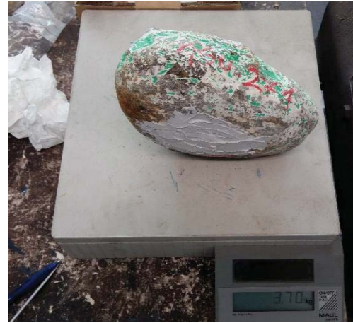
Abbildung C 5-3: Telemetriestein verschlossen mit Karosseriespachtelmasse
