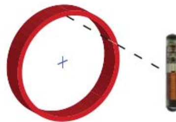
Abbildung C 1-11: Tag Orientierung nicht optimal (Oregon, 2009)
