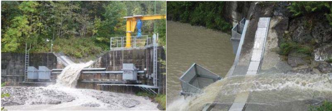
Abbildung B 1-2: Automatisierte Fangkörbe im Erlenbach (Rickenmann, et al., 2012)
