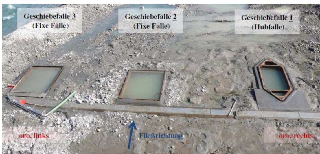
Abbildung A 8-4: Fixe Fallen und Hubfalle (Habersack, et al., 2012)
