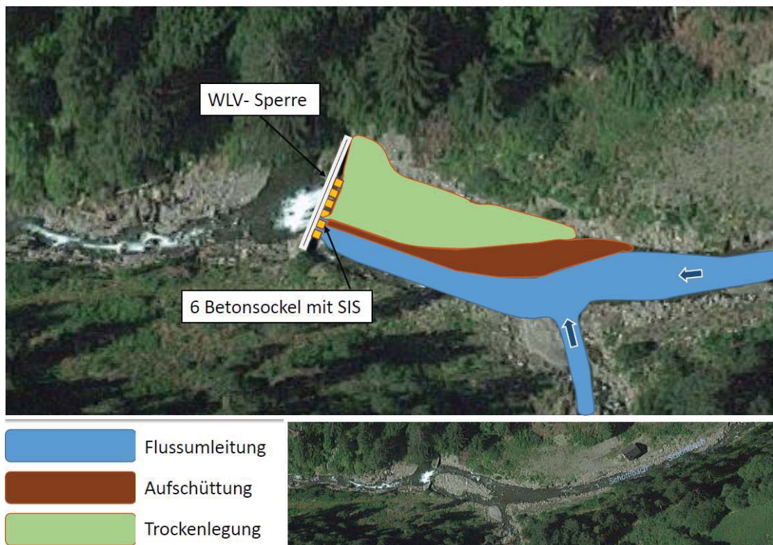
Abbildung B 2-8: Flussumleitung WLV-Sperre
