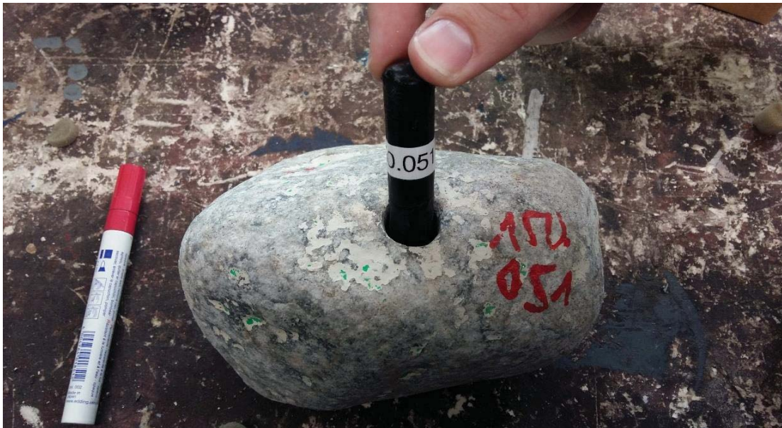
Abbildung C 5-1: Telemetriestein mit Sensor
