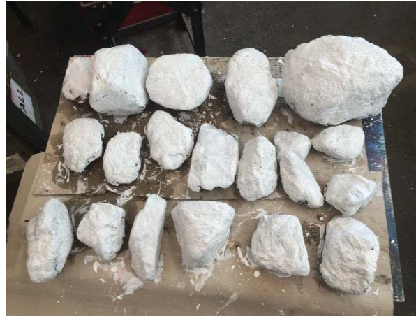
Abbildung C 4-4: Zustand der Farbtracersteine nach der Grundierung
