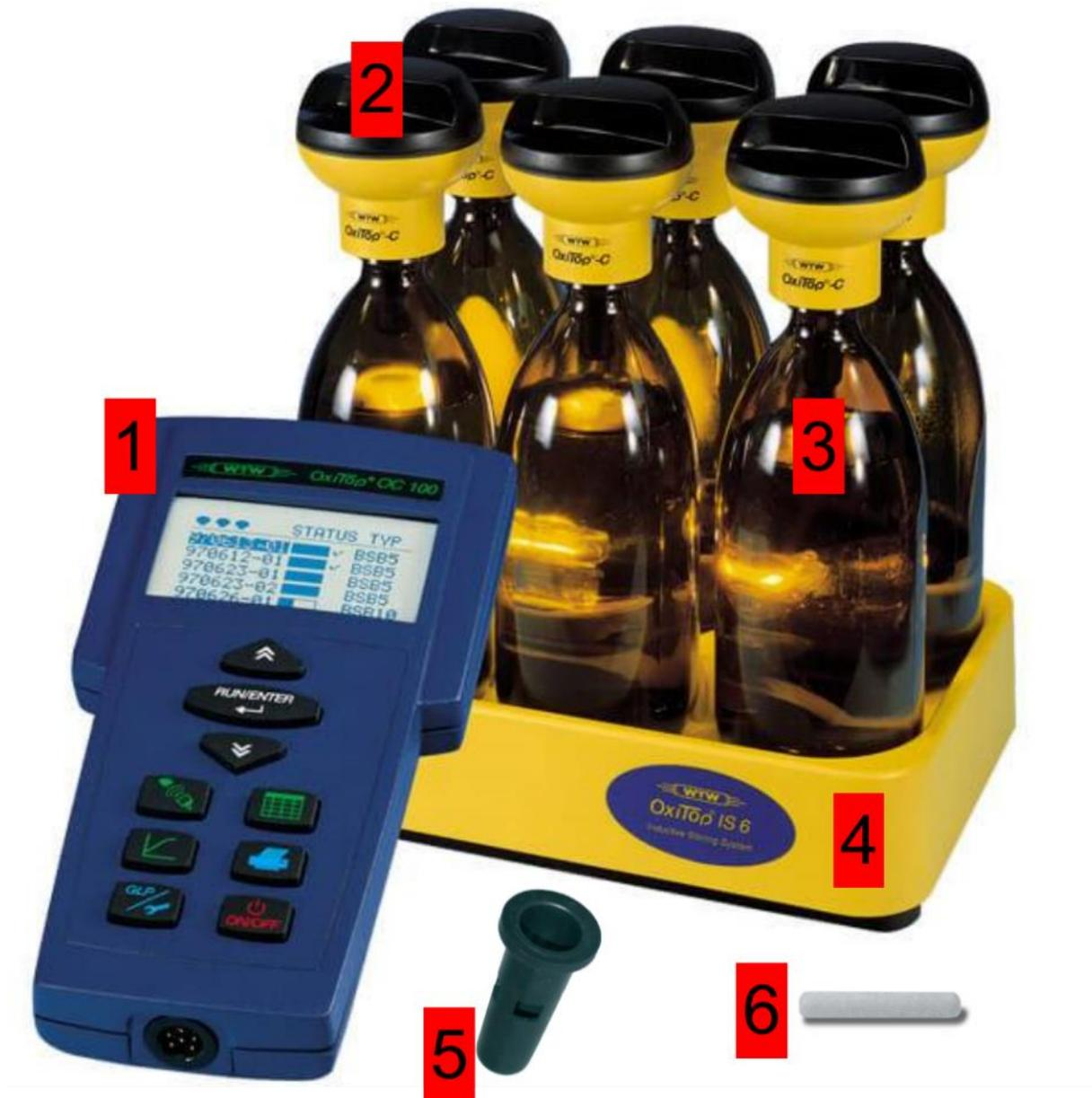
**Abbildung 4-3:** OxiTop-Set: 1) Controller, 2) Messkopf, 3) Gefäß, 4) Magnetrührer, 5) Gummiköcher, 6) Magnetstab (Produktflyer, modifiziert)
