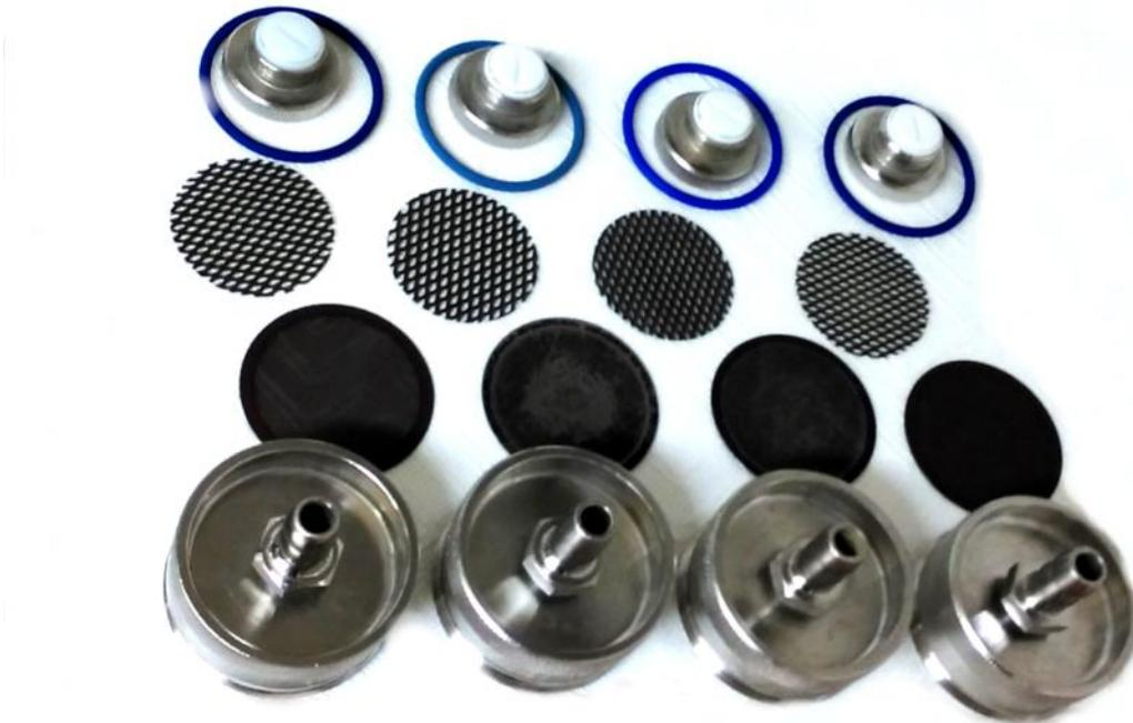
Abbildung 4-7: Vier Paare Unterbau-Schraubverschlüsse zur Aufnahme der Lochbleche, der Siebe, der Filter (nicht dargestellt) und der Dichtringe sowie die vier Zylinderverschlüsse zum Verschließen der Druckfiltrationsgeräte (von unten nach oben aufgelistet)
