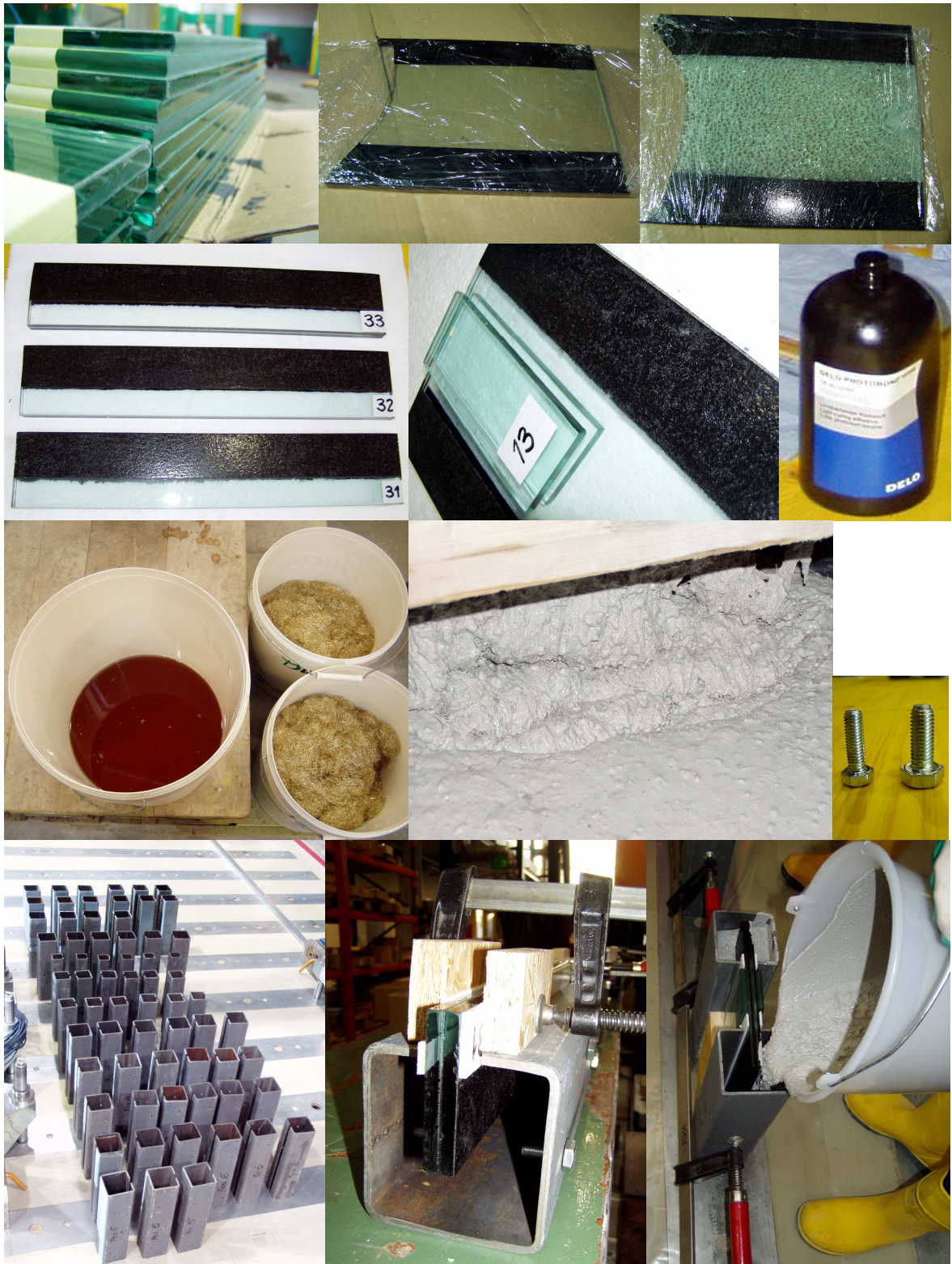
Bild 3.8 Verwendete Materialien: Glas, Beton, Stahl-Hohlprofile, Schrauben, UV-Kleber
