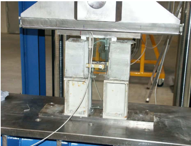
Bild 3.1 Versuchsaufbau des Glas-Beton-Verbund-Versuchs aus [27]
