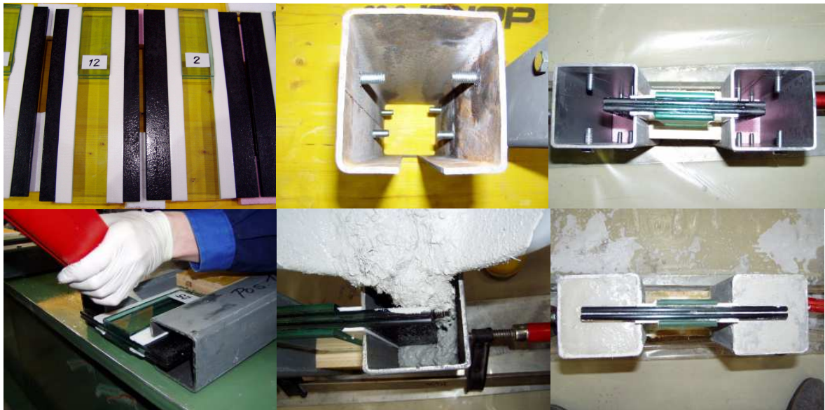
Bild 3.10 Schrittweise Herstellung der Probekörper
