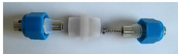
Abbildung 12: Foto einer offenen Swagelokzelle
