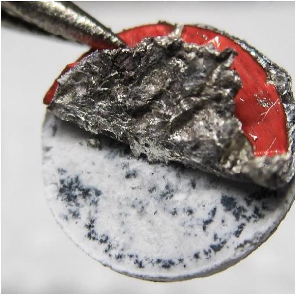
Abbildung 29: Tablette nach CV/GCPL mit schwarzen Dendriten an der Lithium-LiBH<sub>4</sub>-LiI-Grenzfläche
