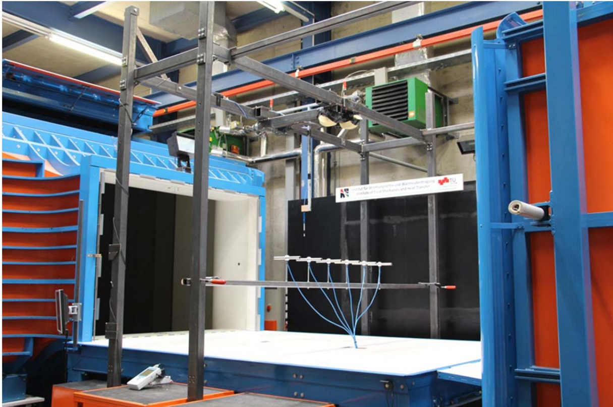
Abbildung 2-10: Kalibrier Aufbau für Sonden im Windkanal
