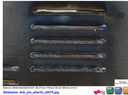
Abbildung 4.9: Schweißungen mit der Strahlfigur der konzentrischen Kreise, Anpassung der Abschmelzhöhe
