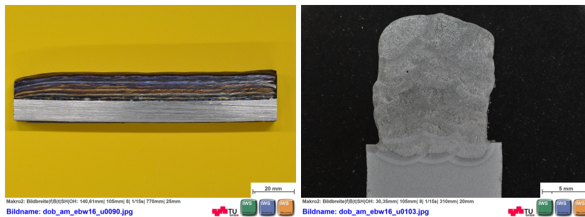
Abbildung 4.14: 3-spuriger 7-Lagen-Aufbau mit Parametersatz aus Tabelle 4.15, Seitenansicht (li), Querschliff (re)
