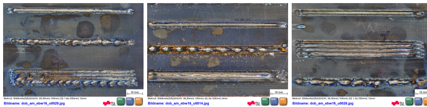
Abbildung 4.11: Mehrlagenschweißungen mit Parametersätzen 1-3 nach den Tabellen 4.11 und 4.10 v.l.n.r.
