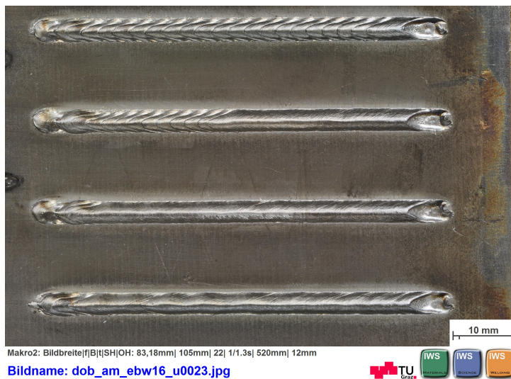
Abbildung 4.3: Feinabstimmung der Drahtzufuhr
