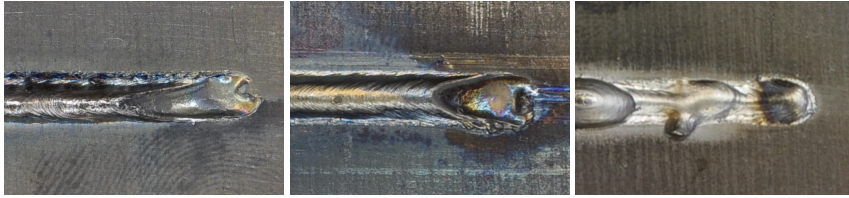
Abbildung 4.2: zu tiefe Drahtzufuhr (links), korrekte Drahtzufuhr (Mitte), zu hohe Drahtzufuhr (rechts)
