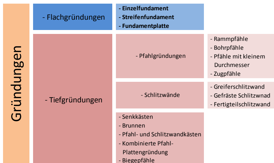
Abbildung 22: Übersicht über unterschiedliche Gründungsarten 80
