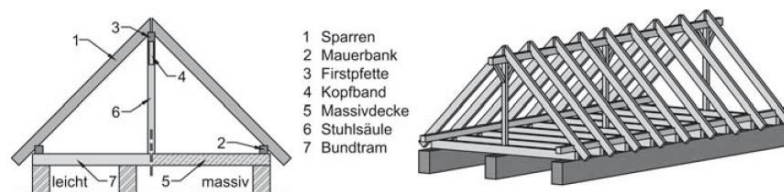
Abbildung 48: Querschnitt und Axonometrie eines Pfettendachstuhls mit einfach stehendem Stuhl 128
