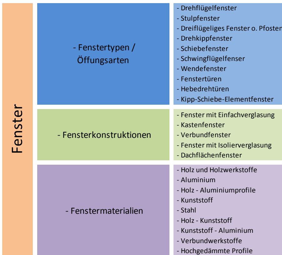
Abbildung 57: Übersicht über unterschiedliche Fenstertypen, -konstruktionen und -materialien 164
