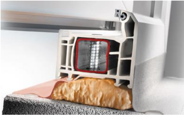
Abbildung 62: RAL Montage. Erkennbar ist das äußere rote und innere graue Dichtungsband. Die mittlere Fuge ist mit Fenster-Montageschaum aufgefüllt. 173
