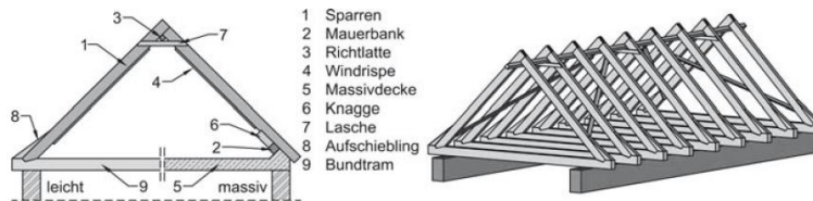
Abbildung 47: Querschnitt und Axonometrie eines einfachen Sparrendachstuhls 126
