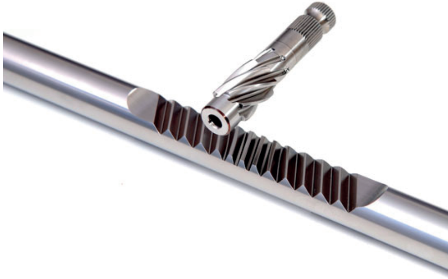
Abbildung 2.15: Zahnstange einer variablen Lenkgetriebeübersetzung (Fahrerorientierter Ansatz) [9]
