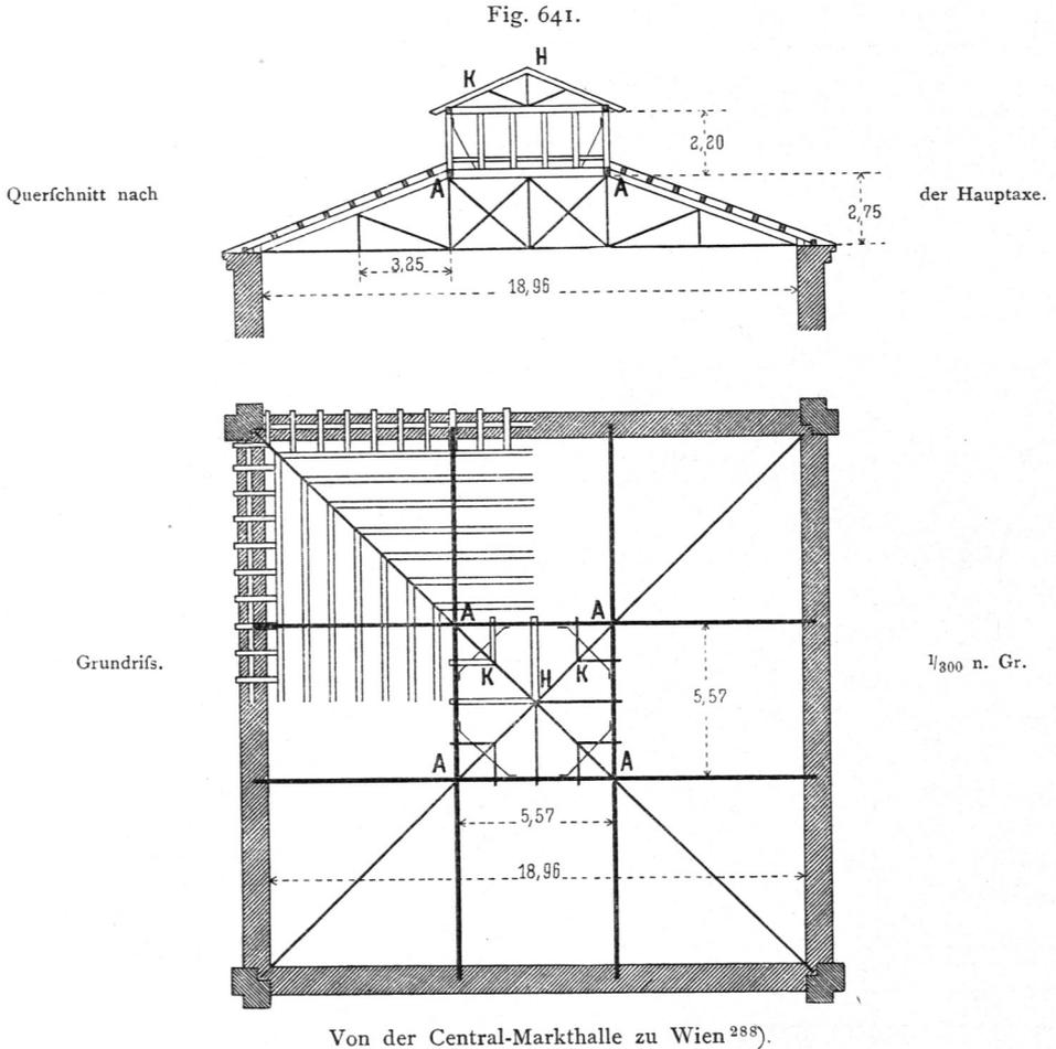
binder parallel zu den Seitenrichtungen des Quadrats; die Hauptbinder durchschneiden einander unter rechten Winkeln und bilden so ein inneres Quadrat für den Laternen-Aufbau.
