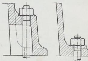
Abb. 1692. Auge am Rahmen für Fundamentanker.
