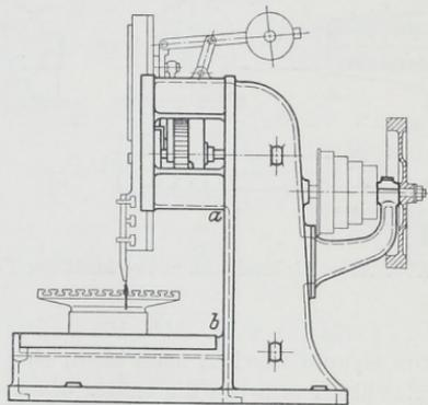
Abb. 1690. Stoßmaschine älterer Form.
