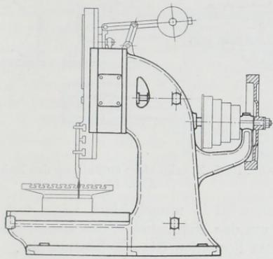
Abb. 1689. Ständer einer Stoßmaschine neuerer Form.
