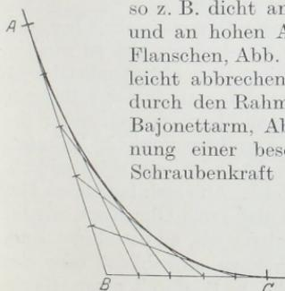
Abb. 1691. Konstruktion parabolischer Übergangskurven.
