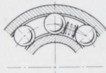
Abb. 1617. Lager mit federnden Zwischenlagen (veraltet).
