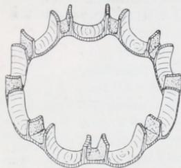
Abb. 1618. Käfig der Deutschen Waffen- und Munitionsfabriken (ältere Ausführung).
