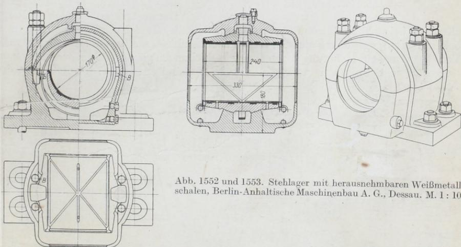
Abb. 1552 und 1553. Stehlager mit herausnehmbaren Weißmetallschalen, Berlin-Anhaltische Maschinenbau A. G., Dessau. M. 1 : 10.
