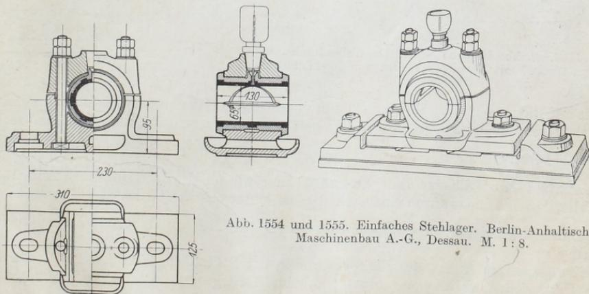
Abb. 1554 und 1555. Einfaches Stehlager. Berlin-Anhaltische Maschinenbau A.-G., Dessau. M. 1 : 8.
