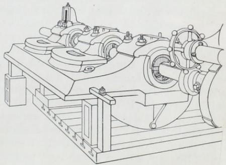
Abb. 1518. Ausbohren von Lagern mittels einer durchgehenden Spindel.
