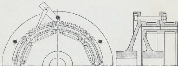
Abb. 1416. Bandkupplung für wechselnde Drehrichtung, Voith, Heidenheim.
