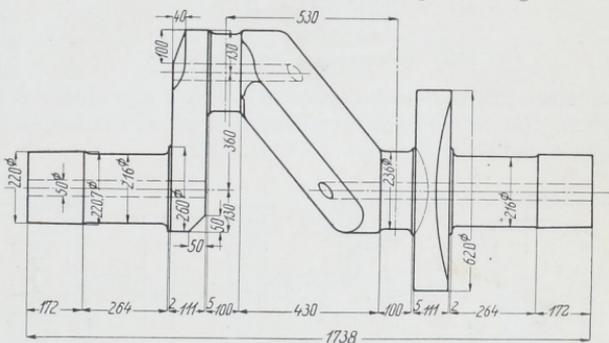
Abb. 1320. Lokomotivachse der österreichischen Staatsbahnen. M. 1 : 20.
