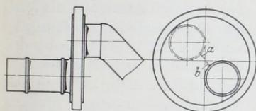
Abb. 1318. Gekröpfte Lokomotivachse.
