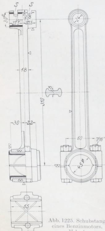
Abb. 1225. Schubstange eines Benzinmotors. M 1 : 4.
