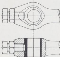
Abb. 1207. Kopf mit Schraubennachstellung.
