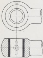
Abb. 1206. Kugelig abgedrehter Schubstangenkopf (Auge.)
