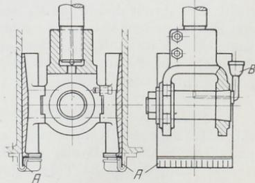
Abb. 1193. Kreuzkopf mit gabelförmigem Hauptkörper.
