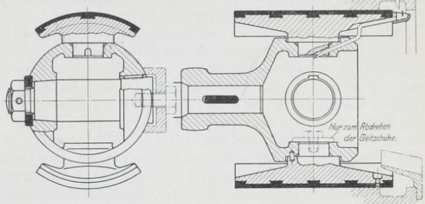
Abb. 1190. Kreuzkopf mit Drehkörper als Grundform.
