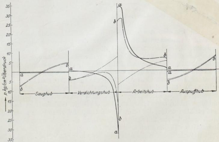
Abb. 1058. Kolbenüberdrucklinie für eine Viertaktmaschine mit Selbstzündung  $a-a$  unter Vernachlässigung der Massenkräfte,  $b-b$  unter Berücksichtigung derselben.
