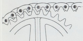
Abb. 2180. Eingriff nach Abnutzung der Zahnkette.
