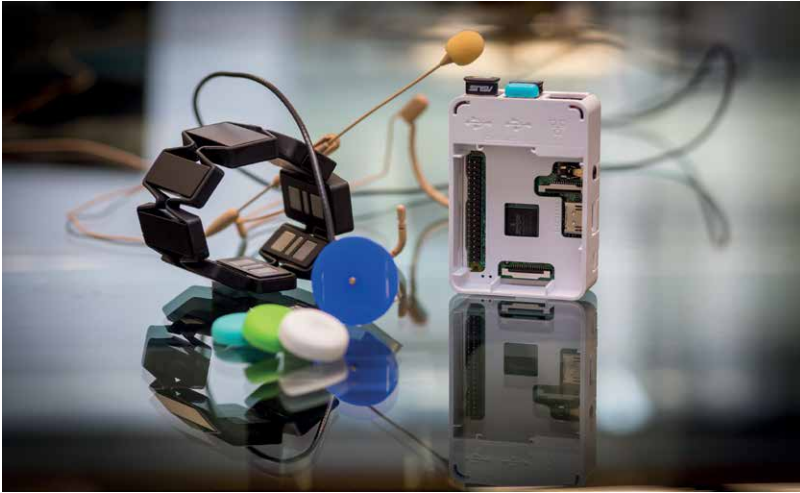
Abbildung 3: Mit dem MYO-Armband kann die elektronische Sprechhilfe gesteuert werden.
