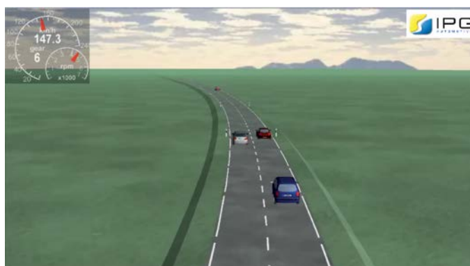
Abbildung 3: Simulation des Regelalgorithmus, der den richtigen Pfad für das autonome Fahrzeug berechnet. Figure 3: Simulation of the algorithm, which calculates the path for the selfdriving vehicle.
