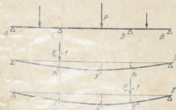
Abb. 1346. Zur Berechnung mehrfach statisch unbestimmter Wellen.
