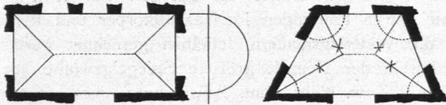
Scheitelpunktes, wie beim Klostergewölbe, tritt eine mehr oder weniger lange Scheitellinie des eigentlichen Tonnengewölbes auf. Die Anschlußpunkte der Kehl- oder Gratlinien der Stirnwalme sind stets die Endpunkte dieser Scheitellinie, gleichgültig, ob die schmalen Stirnseiten rechtwinkelig oder schiefwinkelig zu den längeren, einander parallelen Umfangsmauern des zu überwölbenden Raumes stehen.
