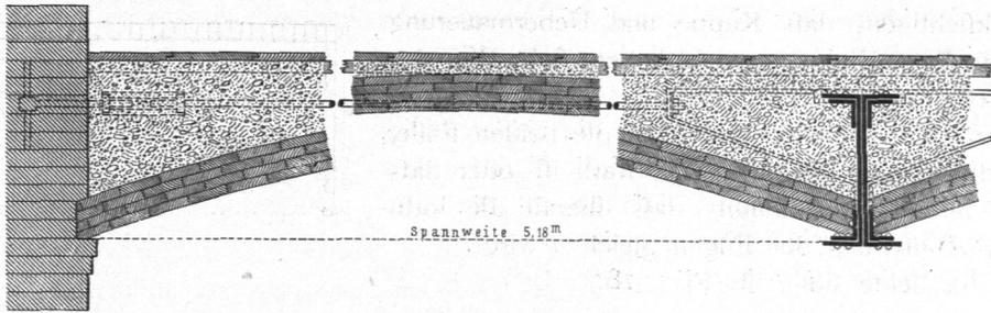
Die Auswölbung der Balkenfache mit Uebermauerung im Scheitel wird namentlich bei Backsteinwölbungen (siehe Fig. 172 bis 174 u. 178) verwendet, ist jedoch auch bei Betonwölbungen verwendbar, wenn man eine Wölbung aus fetter Mischung von der mageren Ueberfüllung gefordert herstellt (siehe Fig. 169 u. 179).
