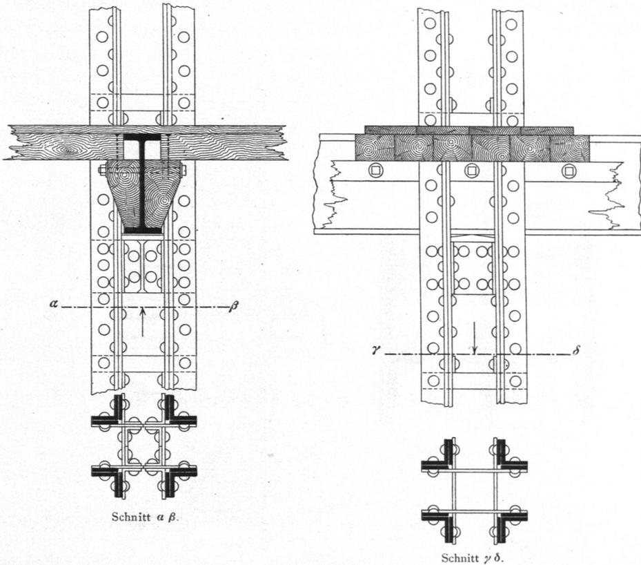
vollkommen, so wie für nicht zu große Belastung auch die Anordnung nach Fig. 17 (S. 14); Fig. 236 bedingt aber eine Balkenlagerung nach Fig. 237 oder 238. Man erkennt hieraus, daß sich kontinuierliche Gelenkunterzüge bei schmiedeeisernen Stützen wesentlich bequemer anordnen lassen, als bei den geschlossenen gußeisernen, wenn nicht die Decke so leicht ist, daß man die Anordnung nach Fig. 17 (S. 14), Fig. 230 oder 235 unbedenklich wählen kann.
