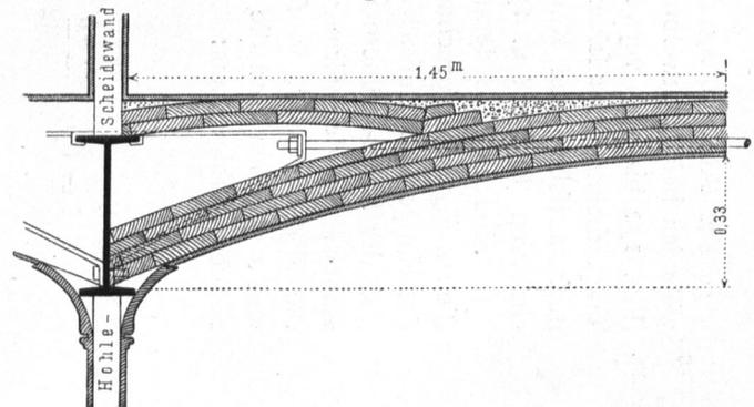
Die Auswölbung der Balkenfache ohne Uebermauerung im Scheitel ist gewöhnlich bei Betonwölbung (Fig. 168 bis 171<sup>125</sup>), jedoch auch bei Backsteinwölbung (Fig. 172 bis 176) verwendbar. Als Weite  $b$  der Wölbung wird in der Regel die Trägertheilung anzusehen sein; doch kann man, genau genommen, auch das Lichtmaß zwischen den Kanten der Trägerflanschen einführen (Fig. 168 u. 170).
