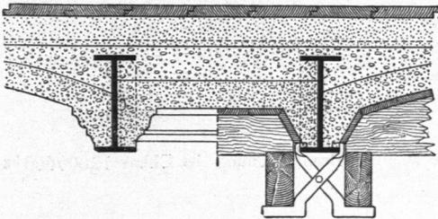
Ein Mittel, die Anker in den Mittelfachen, abgesehen von den Endfachen, zu vermeiden, bietet noch die wechselweise eng und weit angeordnete Trägertheilung nach Fig. 211 u. 212, wenn man jedesmal die enge Theilung mit einer ebenen Betonplatte füllt und diese nebst den sie einfassenden Trägern als einen wagrechten Träger ansieht, welcher die Schübe der benachbarten, mit Kappen geschlossenen, weiten Trägerfache aufnimmt.
