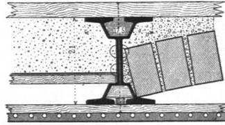
ftimmte Zwecke, namentlich Erzielung größerer Seitensteifigkeit, wie der von *Gocht* (Fig. 200), der von *Klette* (Fig. 201 u. 202) und der mit *Lindsay*-Eisen (Fig. 203 u. 204) unten oder oben und unten verstärkte I-Träger zur Verwendung.
