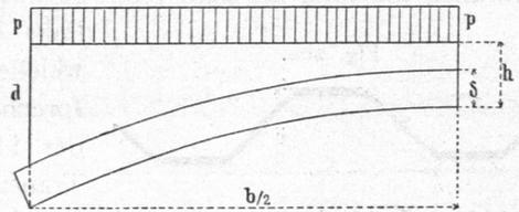
Träger ( $l =$ ) 5,5 m, die Theilung ( $b =$ ) 1,7 m,  $d = 0,12$  m,  $h = 0,20$  m,  $\gamma$  für Backsteine 1700 kg,  $p = 750$  kg und mit Rücksicht auf Stöße für Backstein  $s = 50\,000$  kg für 1 qm. Demnach ist nach Gleichung 6 (S. 97)
