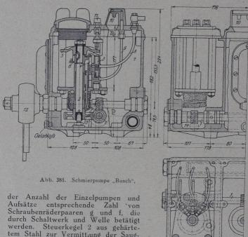
tem Stahl zur Vermittung der Saugund Druckabschnitte und kolben 1 mit selbsttätig wirkender Stopfbüchse bilden eine Einzelpumpe. Beim Einbringen eines Aufsatzes greift
