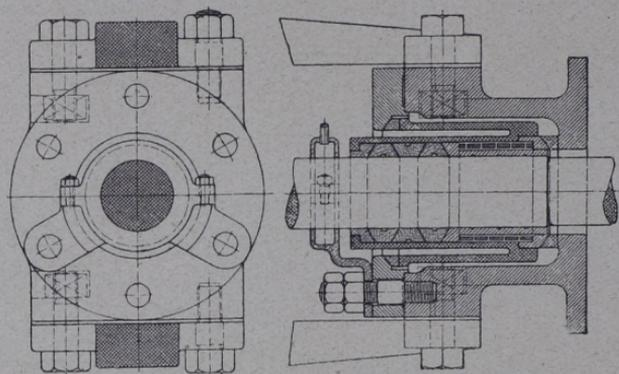
Abb. 343. Hintere Kolbenstangenstopfbüchse nach „Schmidt“.
