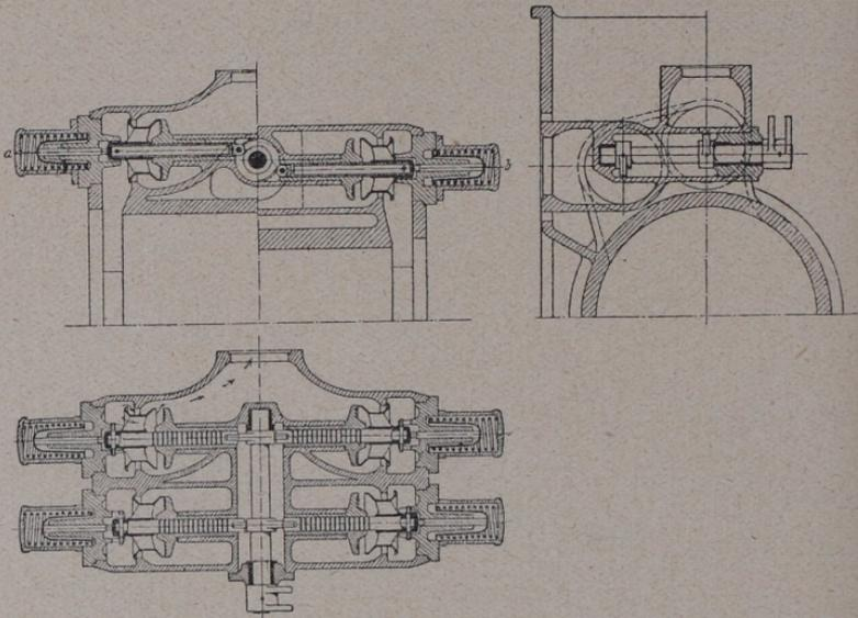
Abb. 286/287. Lenz-Ventile für eine österreichische Lokomotive.
