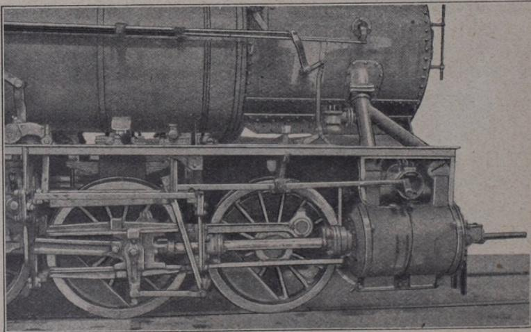
Abb. 288. Lenz-Ventilsteuerung für eine österreichische E-G-Lokomotive.
