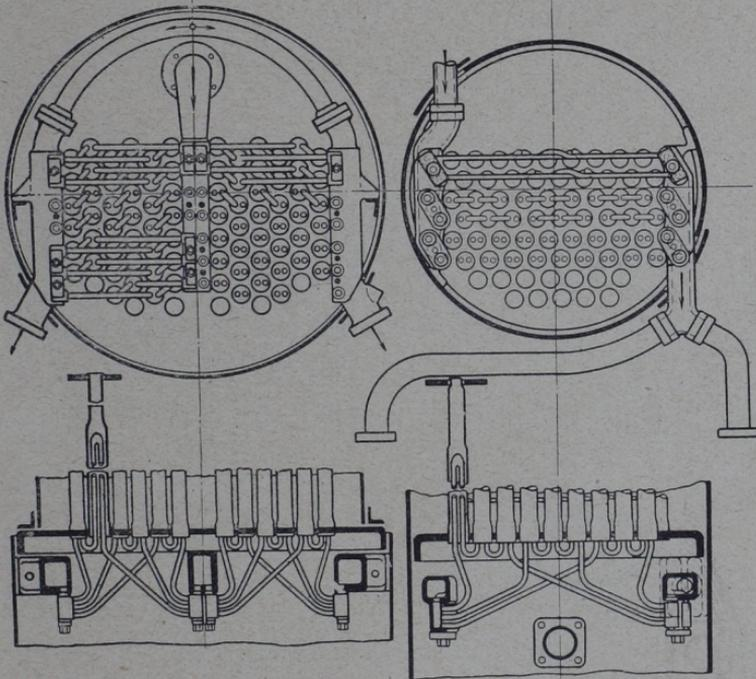
Abb. 145. Anordnung der Sammelkammern in der Mitte und seitlich (Schmidt-Kleinrohrüberhitzer).
