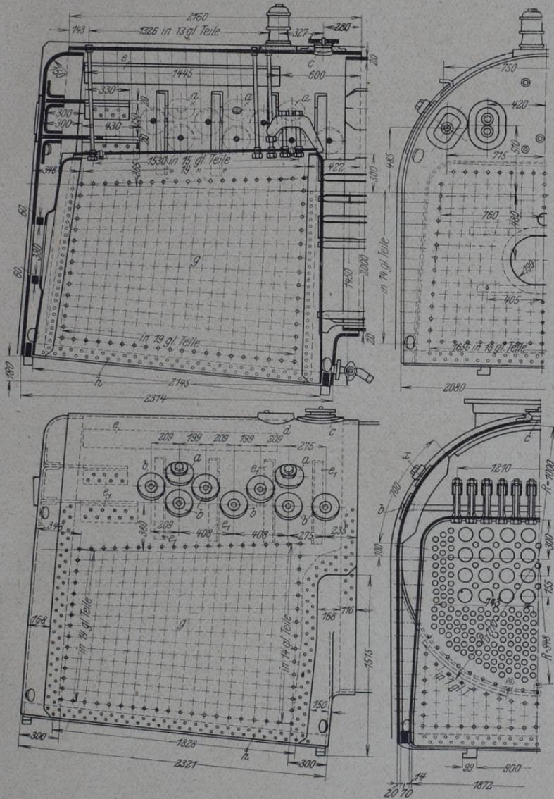
Abb. 85. Hinterkessel der 1E1-Heißdampf-Zwilling-Tenderlokomotive für die Halberstadt-Blankenburger Eisenb.-Ges. (Borsig).
