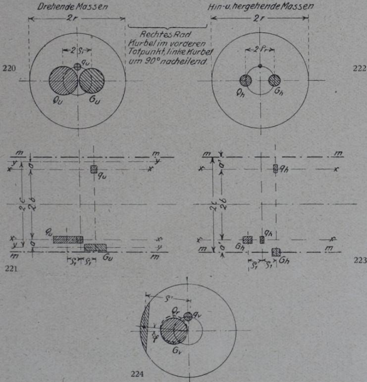
Abb. 220/224. Berechnung der Gegengewichte von Zwillinglokomotiven mit Außenzylindern.
