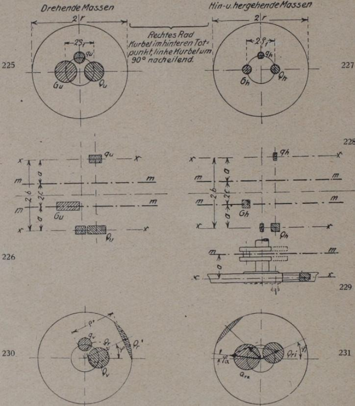
Abb. 225/231. Berechnung der Gegengewichte von Vierzylinderlokomotiven.
