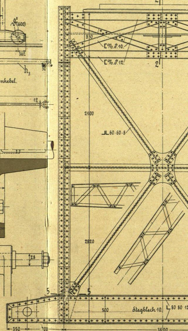
Fig. 6. 1/5. Bremse zum Schwenkwerk
