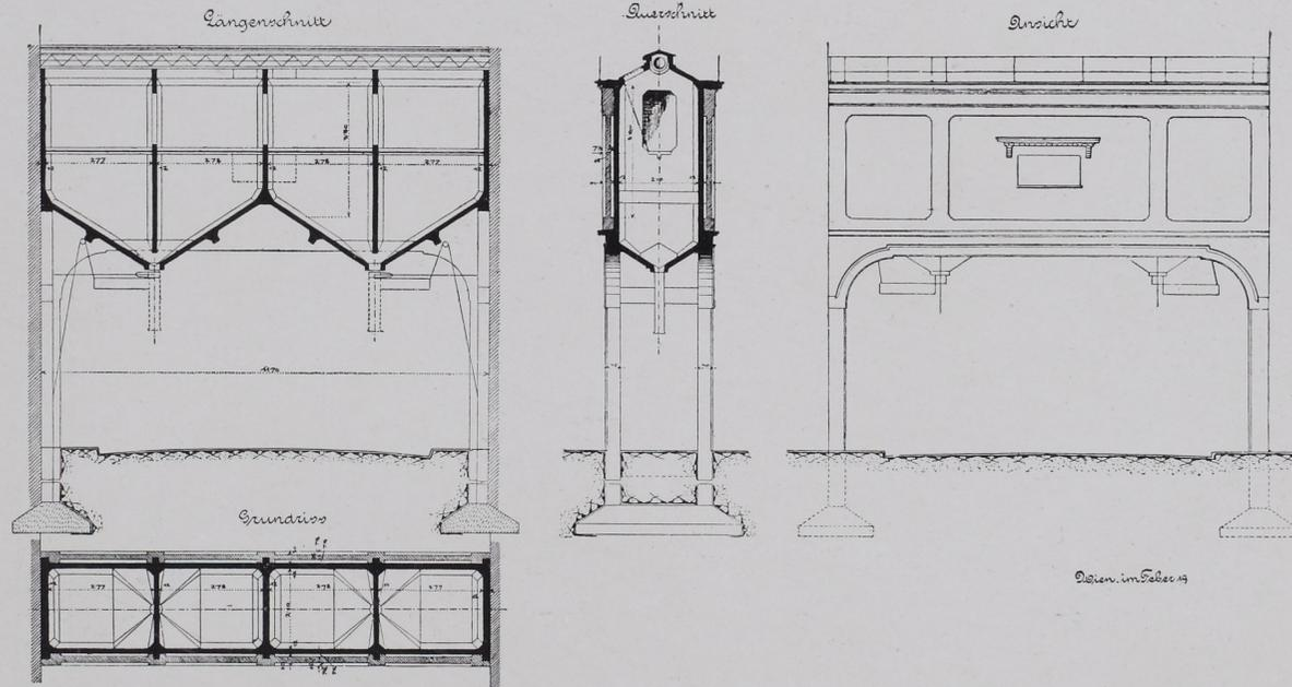
Die gesamten Wände, Säulen und Trichter, sowie die Fundierung auf Platten sind aus armiertem Beton.
