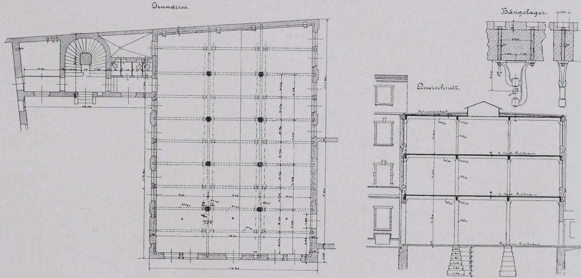
Decken und Säulen aus armiertem Beton System Ast & Co. (verbessertes System Hennebique).
