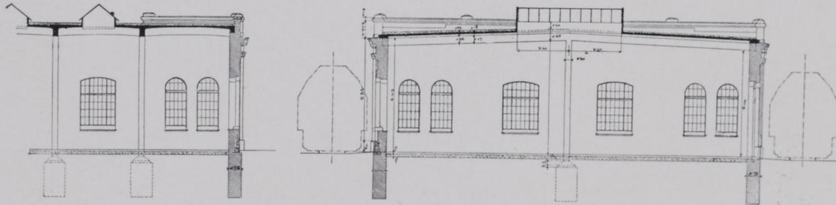
Sheddach mit Oberlichten in armiertem Beton System Ast & Co. (verbessertes System Hennebique).
