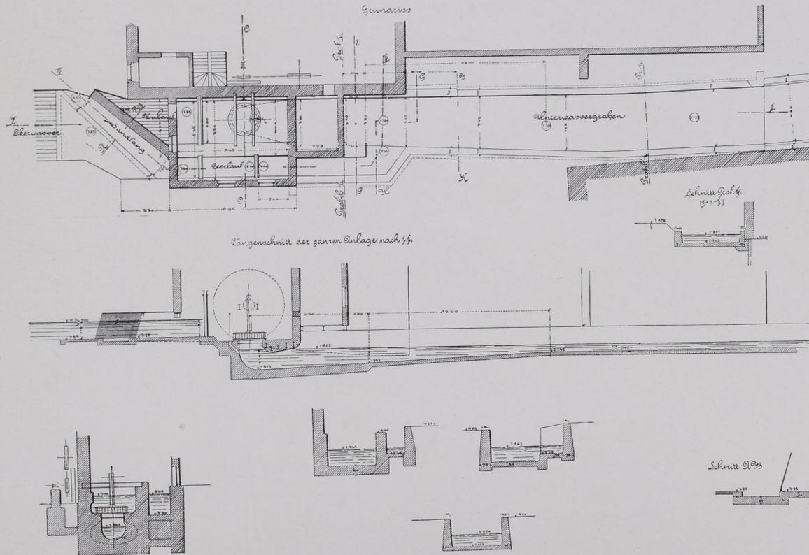
Turbinen-Einbau, Ober- und Unterwassergraben in Portlandzement-Stampfbeton.
