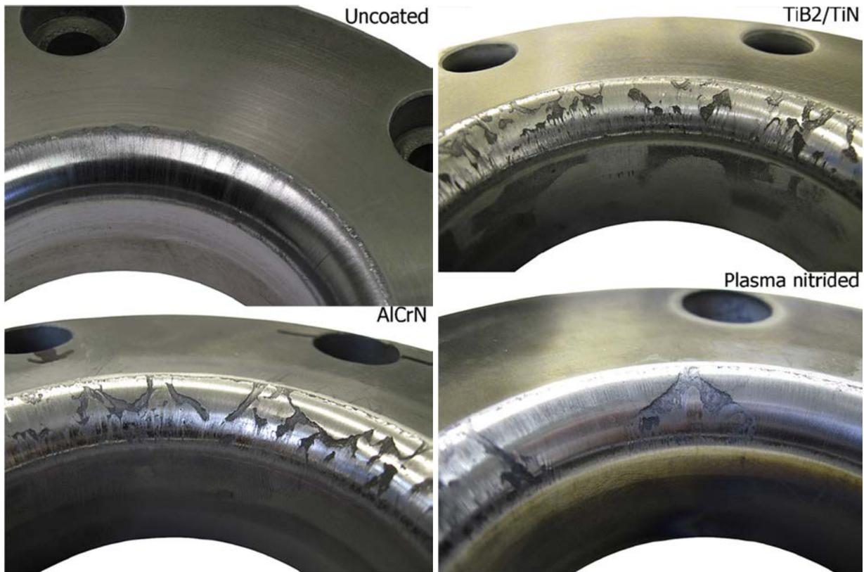
Abbildung 18 Werkzeugverschleiß nach Presshärten von 150 Stk. AlSi beschichteten 22MnB5 Blechen (Kondratiuk und Kuhn 2011)
