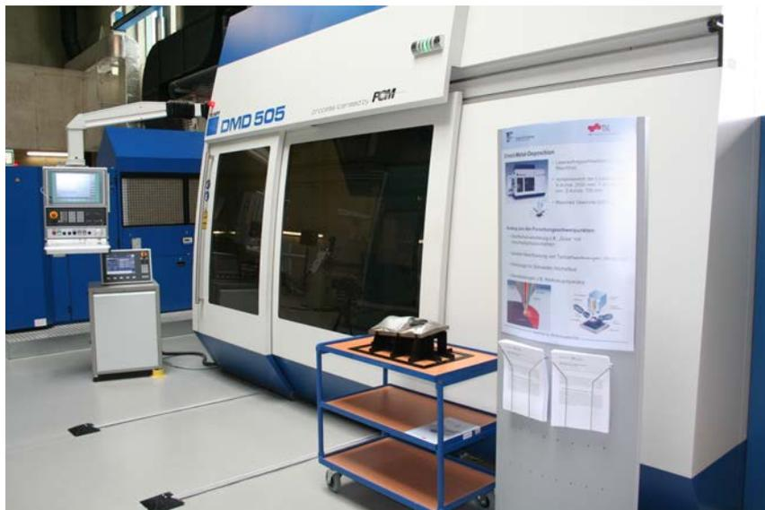
Abbildung 29 Laserzelle zum Auftragsschweißen am Institut für Werkzeugtechnik und Spanlose Produktion
