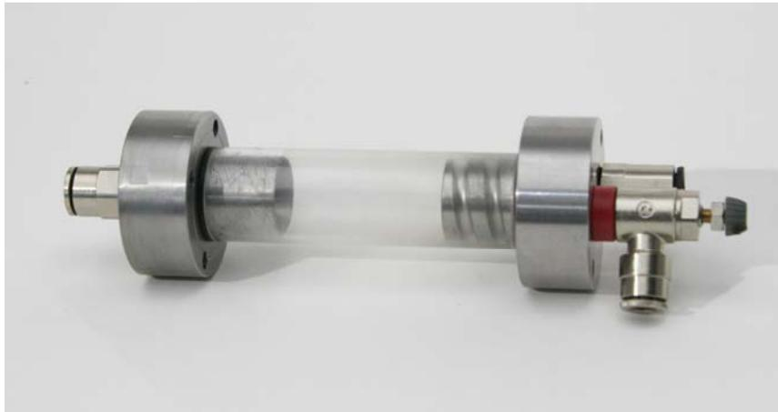
Abbildung 36 Zyklonabscheider mit Drosselventil zur Differenzdruckregelung
