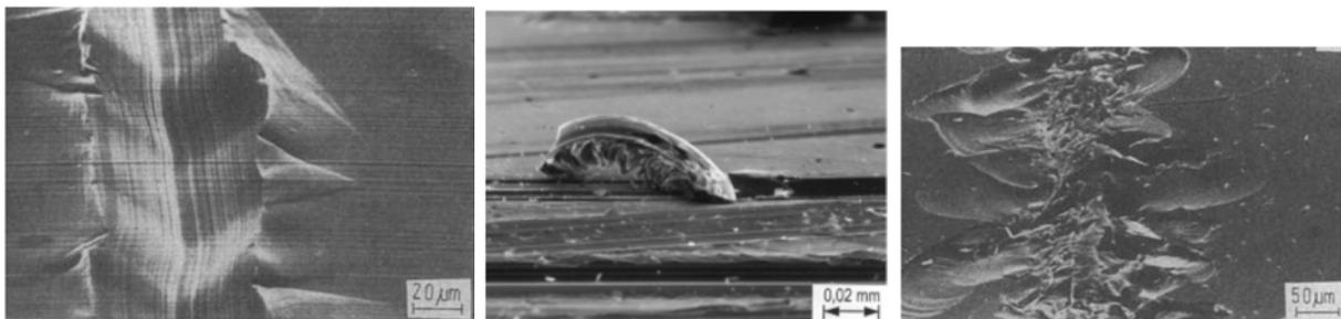
Abbildung 6 Unterschiedliche Auswirkungen von Abrasion (Zum Gahr 1998)
