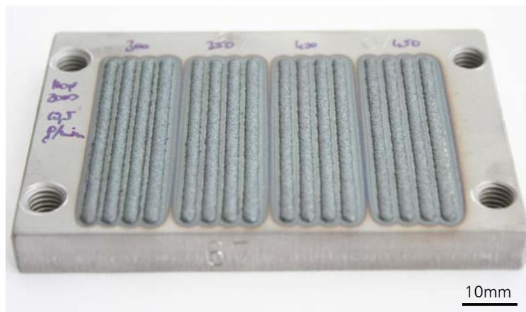
Abbildung 78 Standardisierte Linienprobe für 16 unterschiedliche Schweißparameter zur Evaluierung
