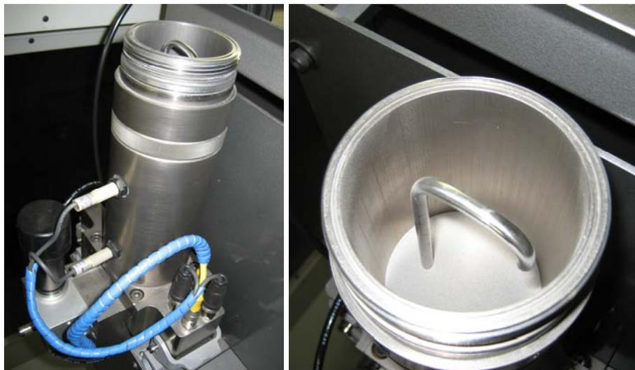
Abbildung 34 Pulverfördereinheit Außenansicht (links) – Füllkammer (rechts)
