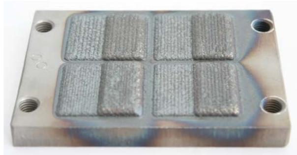
Abbildung 84 Ferro55 auf 1.1730 Vierflächen Vorversuch mit Parametervariation
