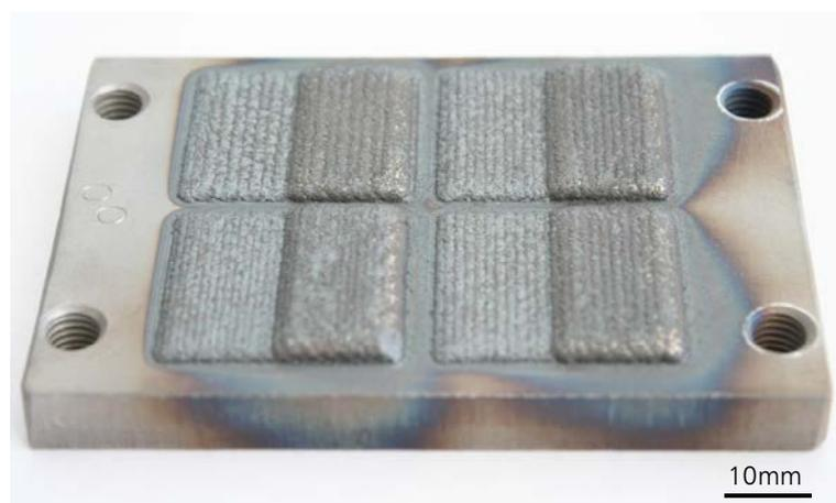
Abbildung 80 Flächenversuche auf Standardprobenkörper mit unterschiedlichen Parametern (Ferro55 auf 1.7131 zwei Lagen)
