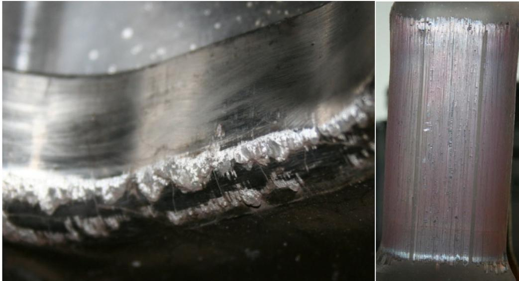
Abbildung 48 Warmformversuche von 1.4034 mit einem vergüteten 1.2379 Werkzeugstahl
