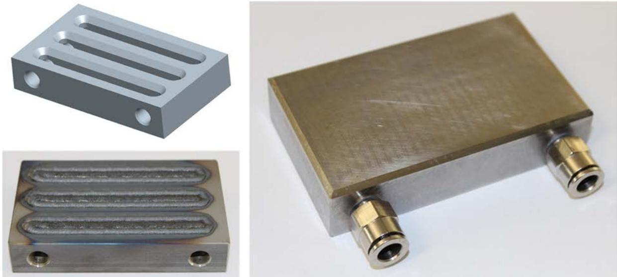
Abbildung 56 Ebene Versuchsplatte mit verschweißten oberflächennahen Kühlkanälen
