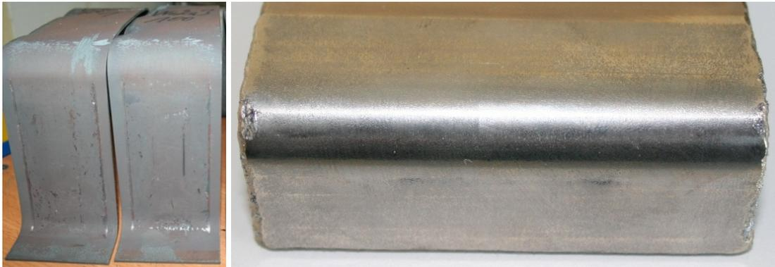
Abbildung 51 100% Wolframkarbide in einer Cu85 Matrix auf Toolox 33
