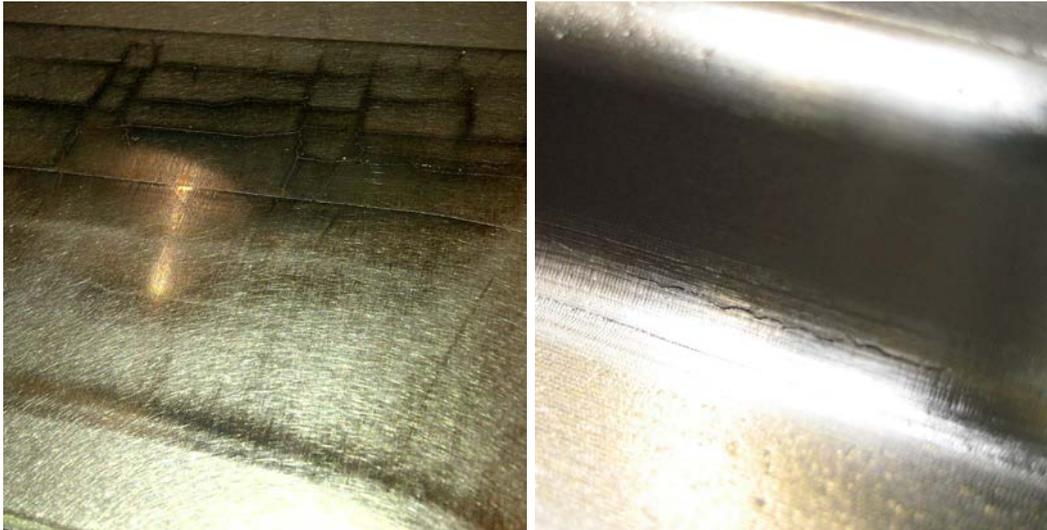
Abbildung 59 Rissbildung in beschichteten Werkzeugkomponenten
