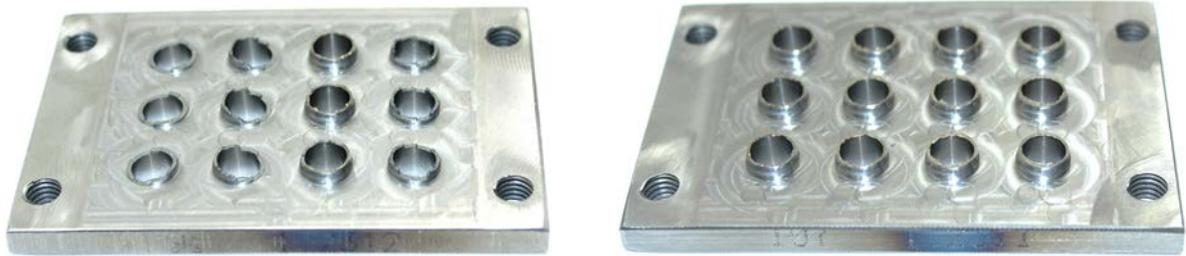
Abbildung 106 Ungültiger Haftfestigkeitsversuch CU85 auf 1.2312 – Bruch außerhalb des Prüfquerschnitts (links)
