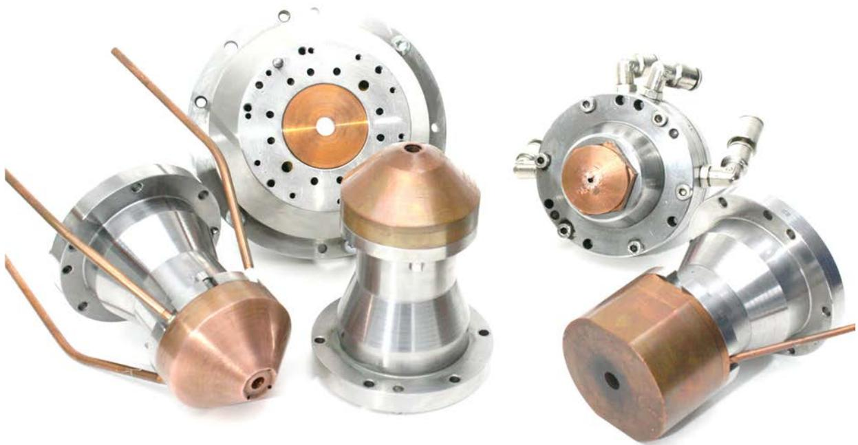
Abbildung 39    Verschiedene Bearbeitungsoptiken für die Versuchsanlage
