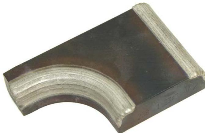
Abbildung 54 Beschichtetes Musterbauteil 1.2343/Ni25/Wolframkarbide vor der Endbearbeitung
