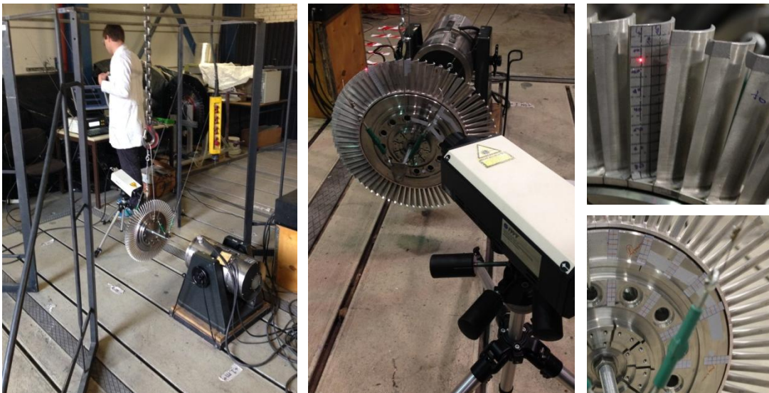
Abbildung 55: Experimentelle Rotorcharakterisierung; Shaker Test [110]
